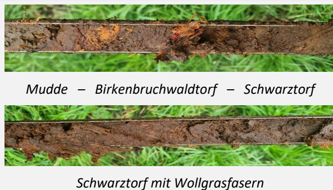
Abbildung 5: Bohrkerne der östlichen Flächen
