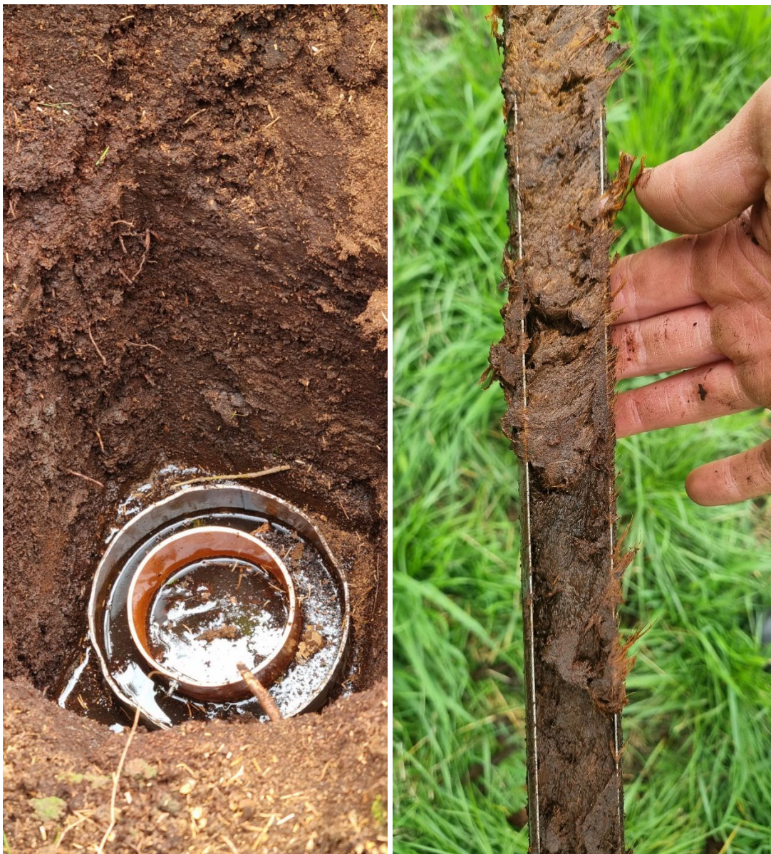
Abbildung 3: Doppelringinfiltrometer (links), „Guts“-Stechbohrer mit Profilkern (rechts)
