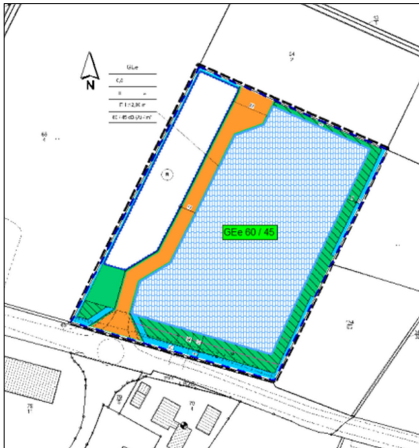
Abb. 10: Lage der Flächenschallquelle für die Emissionskontingente im Geltungsbereich des B-Planes, ohne Maßstab
