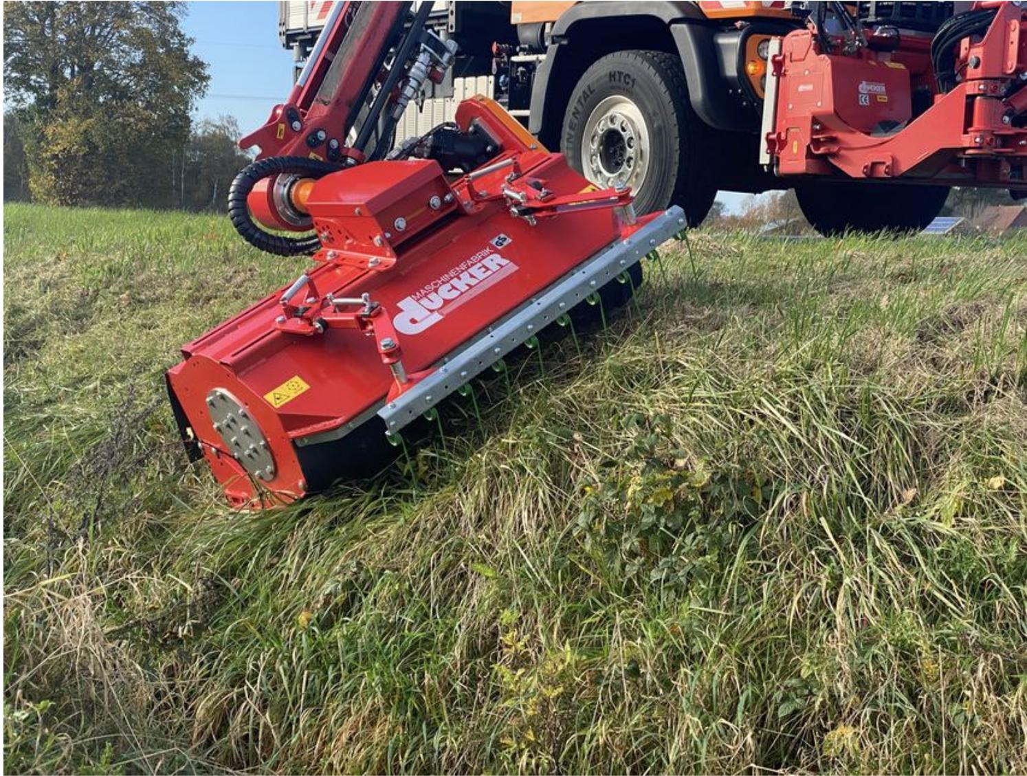
**Der Schlegelmähkopf VMS 1200 ÖKO wird über einen Zahnriemenantrieb angetrieben.**
